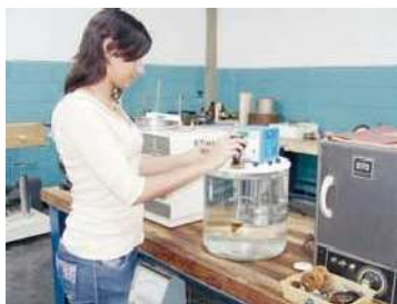
Este es el viscosímetro, que permite el baño termostático para la determinación de la viscosidad cinemática
