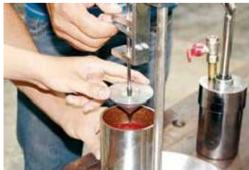
Determinación de la consistencia de la grasa lubricante en el penetrómetro
