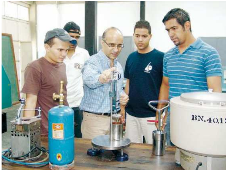
El profesor Francisco Saldívar indica el uso del penetrómetro, que permite la determinación de la consistencia de una grasa lubricante
